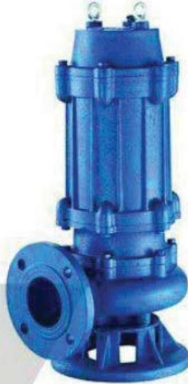
در این پمپ ، الکتروموتور مورد استفاده از نوع سه فاز ۳۸۰ ولت می باشد . به سبب لزوم خنک کاری الکتروموتور و جلوگیری از ارتعاش ، الکتروپمپ در شرایط خشک استارت نشود و لازم به ذکر است که جهت نصب این نوع الکتروپمپ ها احتیاجی به شرایط خاص محل نصب نبوده و به راحتی با قراردادن الکتروپمپ در داخل سیال مورد نظر و نصب اتصالات الکتریکی و لوله تخلیه نسبت به پمپاژ سیال می توان اقدام نمود .
